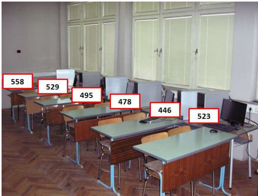
Фиг. 2. Осветеност на работните места в компютърна зала (Условия на осветление – включено изкуствено осветление и затворени щори)
